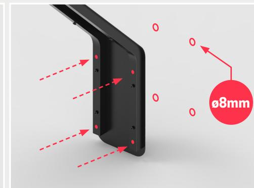
▪ Marca los 4 taladros y taladra la pared con una broca de  $\varnothing 8\text{mm}$
