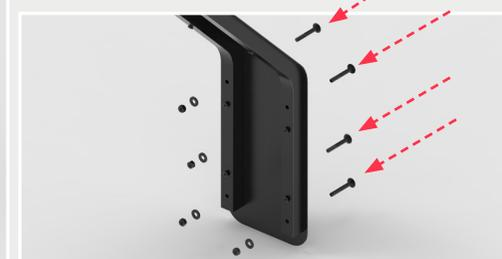
▪ Recomendamos colocar la parte inferior del soporte a 250 mm de la parte superior del terraplén para una altura de pantalla de 1400 mm.
