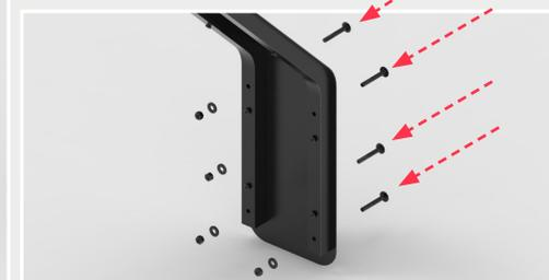
▪ Si consiglia di posizionare la parte inferiore della staffa a 250 mm dalla parte superiore della ringhiera in modo da avere un'altezza dello schermo di 1400 mm
