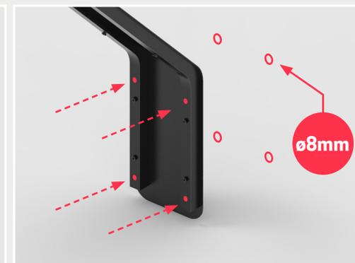
Segnare i 4 buchi di foratura e trapanare la parete con una punta da  $\varnothing 8\text{mm}$
