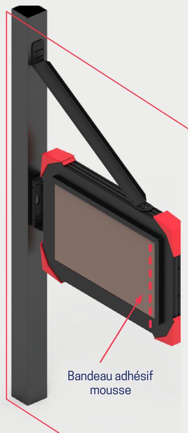
**10** - Repositionner l'écran avec le bras du support pour remettre l'écran de niveau.
